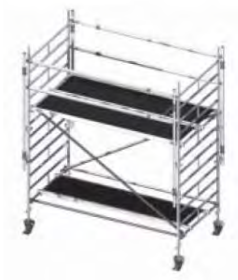
Figura 9 Finalización del piso de trabajo con barandillas y rodapiés perimetrales
