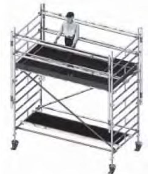
Figura 9 Finalización del piso de trabajo con barandillas y rodapiés perimetrales
