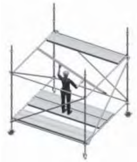
Figura 4 Montaje de la protección superior (pies y largueros de seguridad)
