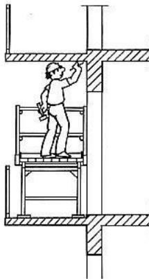
Fig. 9: Andamio situado en voladizo
