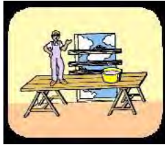
Fig. 16: Andamio situado junto abertura en pared protegida
