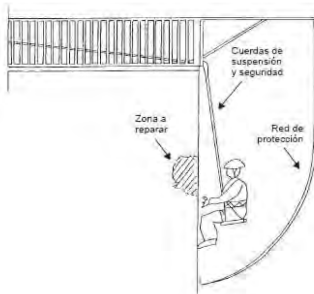
Figura 9 Protección total de la fachada. Partes y dimensionado
