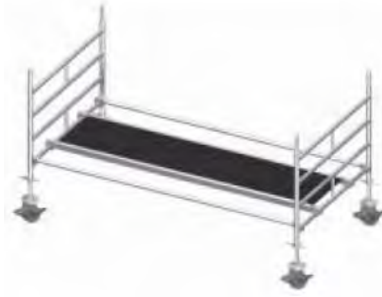
Figura 6 Montaje de ruedas en marcos, barandillas de unión y plataforma auxiliar
