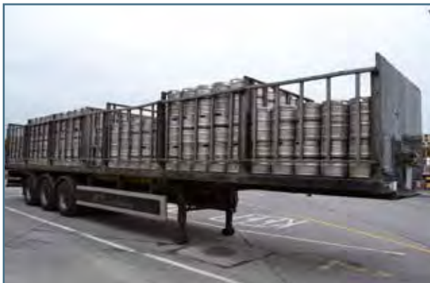
Fig. 12. Bloqueo mediante el panel delantero y las paredes laterales.
