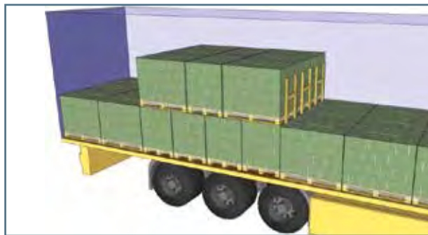
Fig. 18. Bloqueo por paneles hacia delante en segundo piso.
