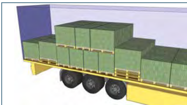
Fig. 17. Umbral de bloqueo de la capa superior hacia delante.
