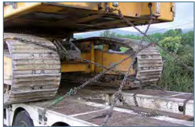
Fig. 39. Excavadora con una fijación oblicua por cadenas.
