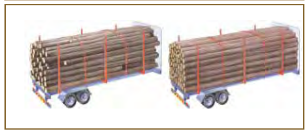
Fig. 66. La sujeción de la carga debe ejercer siempre una presión vertical sobre los troncos.
