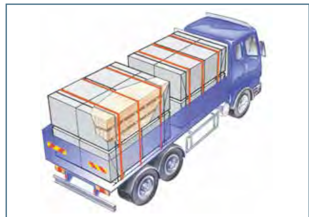
Fig. 51. Carga completa de tablonos fijada.
