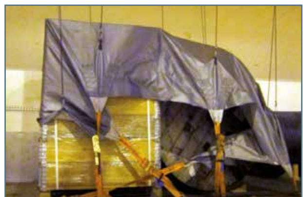
Fig. 42. Sistemas de retención con correas integradas.
