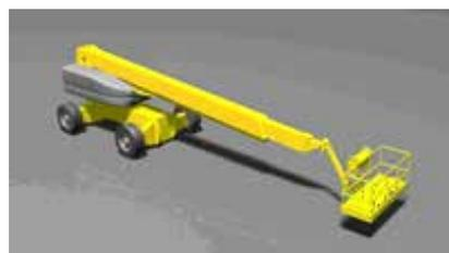
Figura 7. PEMP de estructura telescópica
