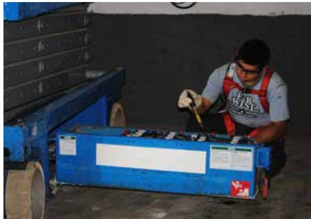
Figura 24. Falta de EPI en la comprobación o manipulación de las baterías
