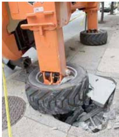
Figura 13. Apoyo de PEMP sobre una superficie poco resistente
